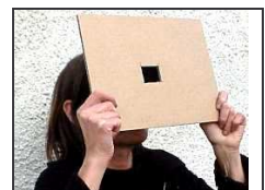
Filtre en polymère fixé sur un carton percé.
